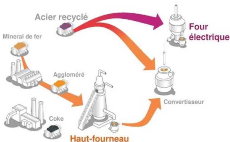
Figure 2. Filière de fabrication avec un haut-fourneau et un four électrique (Source : https://france.arcelormittal.com/ )
